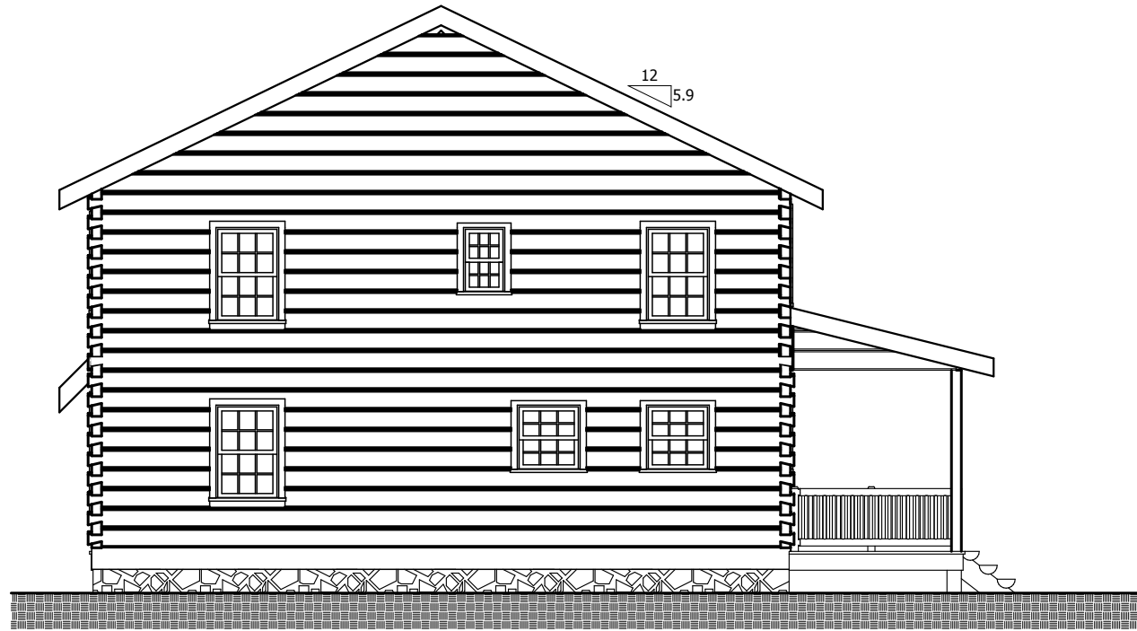
○ REAR ELEVATION SCALE: 1/8" = 1'-0"
