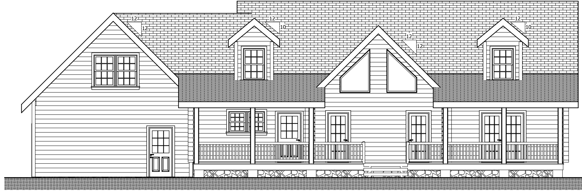
○ REAR ELEVATION SCALE: 1/8" = 1'-0"
